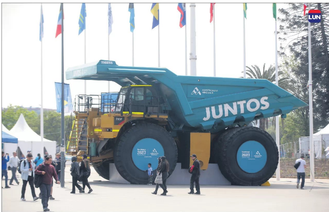
Este CAEX puede transportar hasta 220 toneladas (hay algunos que transportan hasta 360 toneladas)
