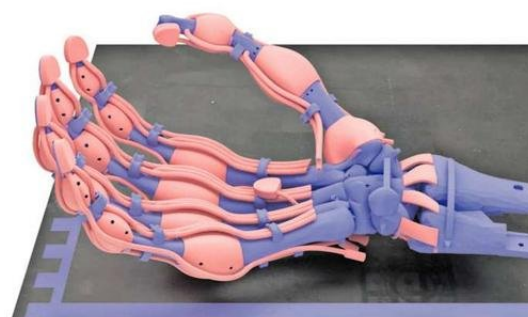
PINZA ROBÓTICA IMPRESA EN 3D CON FORMA DE MANO HUMANA Y CONTROLADA POR 19 TENDONES DEL CIENTÍFICO JAVIER RAMOS.
