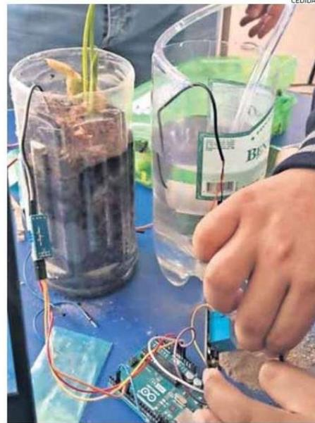
UNO DE LOS PROTOTIPOS DEL RIEGO AUTOMÁTICO.
