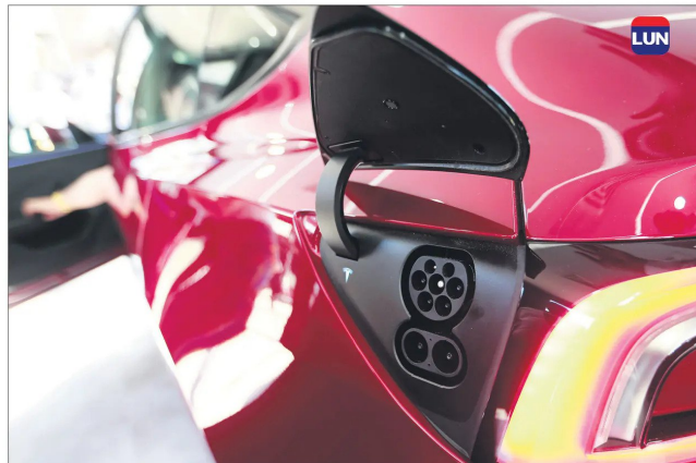
Vienen con conectores tipo 2 para usarlos en los cargadores públicos.
