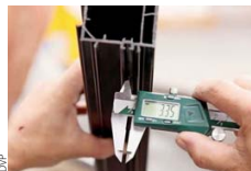
Proceso de medición de parámetros de perfiles para ventanas de PVC.
