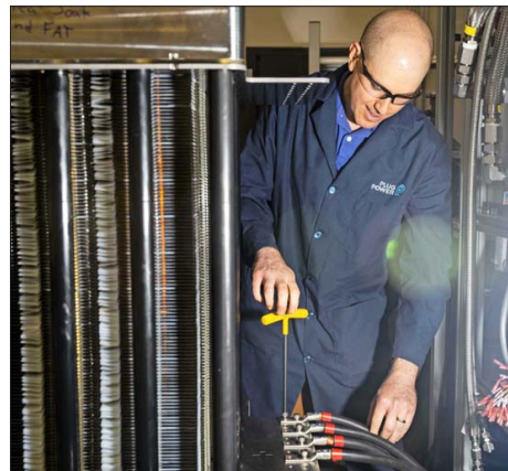
Un equipo que produce hidrógeno al separarlo del agua.
