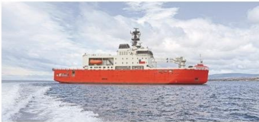
El buque tiene 111 metros de eslora (largo) y una manga (ancho) de 21 metros, además de un calado de 7,2.
