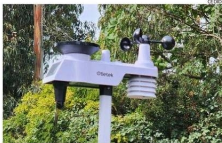
EL EQUIPO MIDE TEMPERATURA, LLUVIA, VIENTO Y HELADAS.
