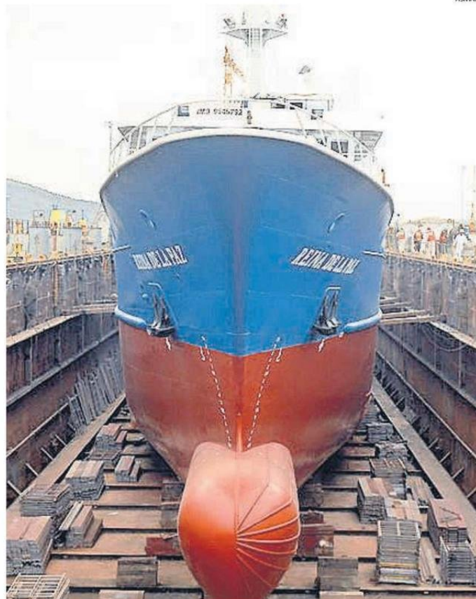
EL DIQUE FLOTANTE "MERY" DE ASMAR TALCAHUANO TIENE 120 METROS DE ESLORA (LONGITUD).
