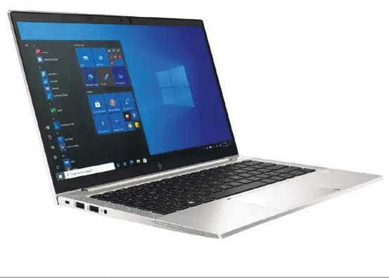
La batería de 56 W del nuevo HP permite una carga rápida del 50% en media hora.
