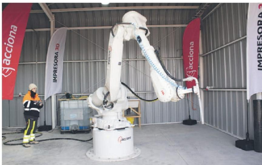
El brazo robótico de impresión 3D en hormigón de ACCIONA permitirá que alumnos y profesores de las carreras de Automatización y Robótica, Mantenimiento Industrial y Construcción puedan practicar con esta nueva tecnología.
