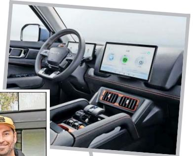
Cuenta con una pantalla giratoria multimedia de 12,8 pulgadas y el panel de instrumento LCD de 10,25 pulgadas.
