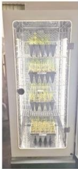
Un ensayo de pruebas con plantas forrajeras, comparando el crecimiento con y sin la aplicación del consorcio bacteriano en cámara de crecimiento que simula temperaturas locales para observar el crecimiento.
