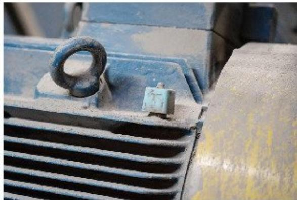
La Unidad de Monitoreo de Condiciones de la minera instaló dispositivos que miden la vibración de equipos en la Planta Concentradora, que obtienen datos 24/7 que permiten generar modelos predictivos de fallas, además de eliminar la exposición de trabajadores(as), que antes realizaban las mediciones de forma manual.
