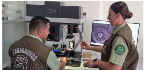
biológicas "Crime Lite PRO" que detecta evidencias posiblemente portadoras de ADN y otros elementos de interés criminalístico. Dicho equipo cuenta con iluminación UV-Vis-IR completamente integrada y sistema de imagen con "ópticas inteligentes", por lo cual puede utilizarse para marcar evidencias, detectar la presencia de fluidos corporales y localizar
