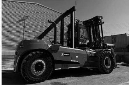
Entre sus características destacan su mástil doble para 4 metros de altura, cabina de visión total completamente suspendida (HCCS), motor diésel Tier 4F de bajas emisiones, joystick de mando, sistema antivuelco y estabilidad direccional mejorada. Está equipada con balizas, extintores, rejas de protección y cámaras frontales y traseras. Dercomaq garantiza su mantenimiento y disponibilidad para proyectos de gran escala, asegurando operaciones más seguras y eficientes.
