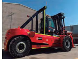
La grúa cuenta con un mástil doble que alcanza los 4 metros de altura y una cabina completamente suspendida de visión total (HCCS), pensada para mejorar la comodidad y seguridad del operador. Integra un motor diésel Tier 4F, que cumple con normativas de bajas emisiones, joystick de mando, sistema antivuelco y mayor estabilidad direccional. Además, viene equipada de fábrica con cámaras frontal y trasera, rejillas de protección, balizas y extintores.
