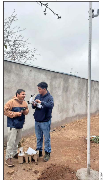
Los módulos, diseñados por los universitarios en la asignatura Didáctica de las Ciencias, permiten medir la cantidad de lluvia, la presión atmosférica y la dirección del viento, entre otros.
