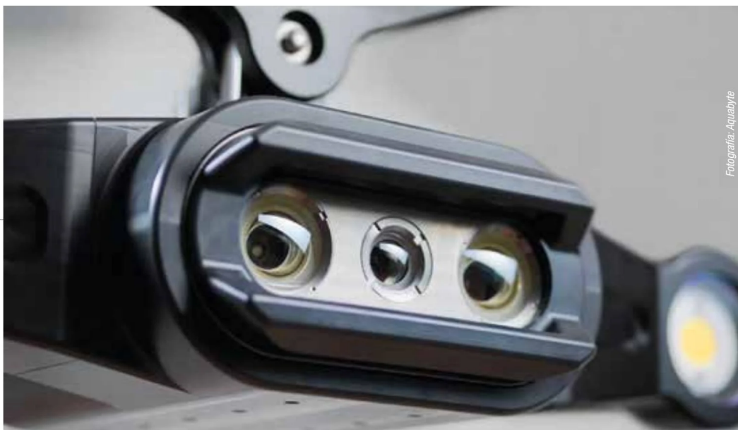
Cámara para estimación de parámetros clave de Aquabyte.
