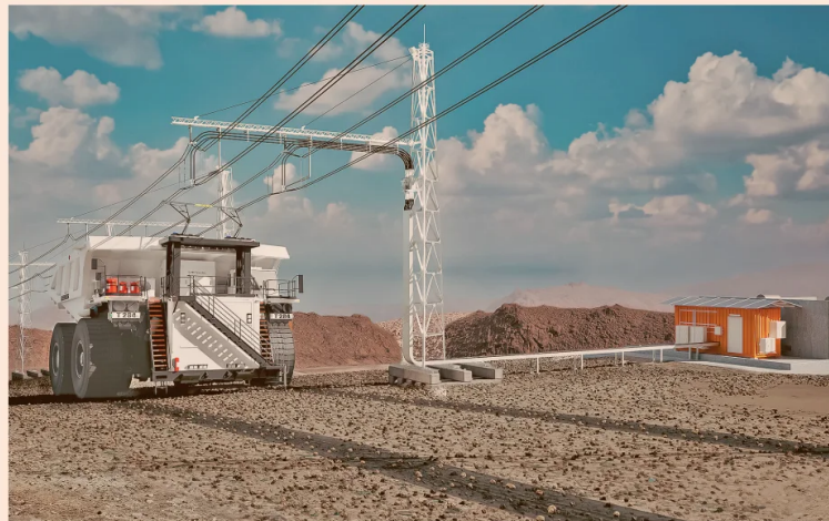
Esquema de ingeniería inicial de sistema eléctrico basado en la lógica de una catenaria aérea energizada en corriente continua (CC).
