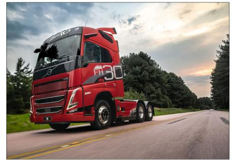
combustible y cambios de marcha precisos, así como con el freno motor VEB+ (Volvo Engine Brake Plus), que proporciona hasta 510 HP de potencia de frenado, aumentando la seguridad en pendientes pronunciadas.
