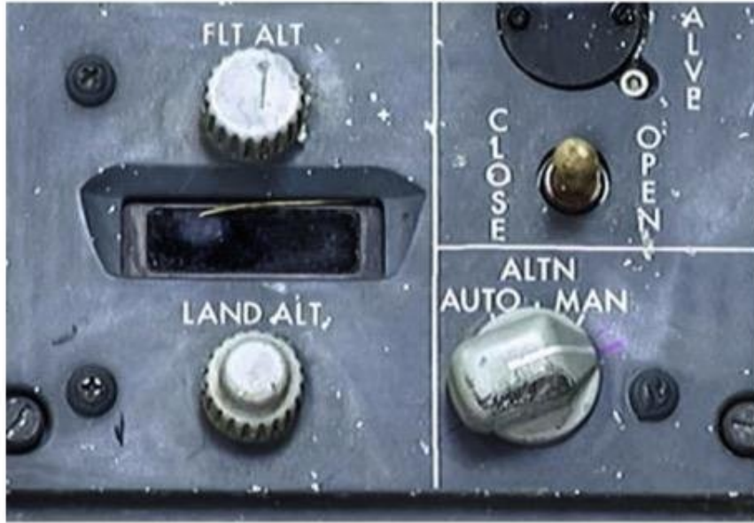
El interruptor del control de presión de la cabina, recuperado del lugar del siniestro.
