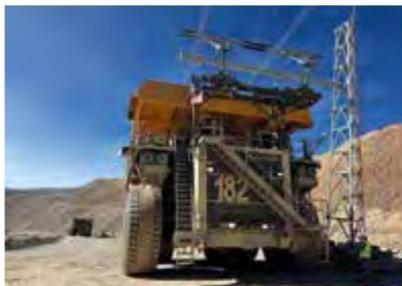
365 toneladas, fueron adaptados para conectarse a través de un pantógrafo a una red eléctrica aérea mediante un brazo retráctil que alimenta los motores durante el trayecto, reduciendo en un 98 % el consumo de diésel y en un 97,6 % las emisiones de CO<sub>2</sub> en ese tramo.
