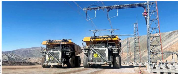
La línea Trolley implementada en Minera Collahuasi está diseñada para soportar la operación simultánea de dos camiones Liebherr T 284 de 400 Ton.
