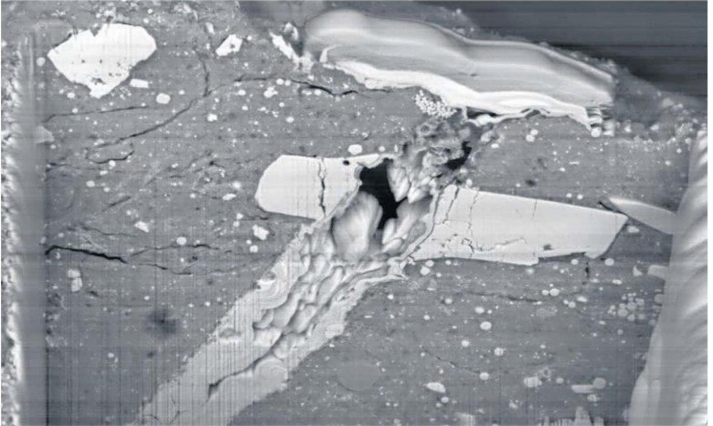
Imagen de microscopio electrónico de barrido del cráter de impacto de micrometeorito en una partícula de material de Benu.
