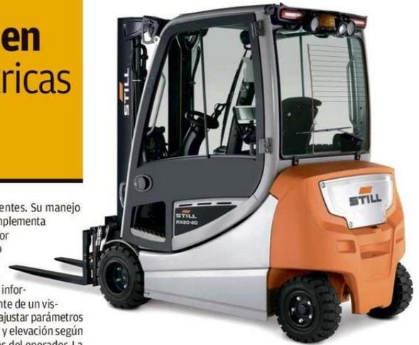
tor híbrido diésel-eléctrico de alto rendimiento con bajo consumo y mínimas emisiones. Ofrece velocidad de traslación de hasta 21 km/h y permite operar de manera simultánea en traslación y elevación. Su cabina ergonómica con columna de dirección ajustable, visión panorámica y control a bordo STILL Easy Control refuerzan la seguridad y el confort. Además,
