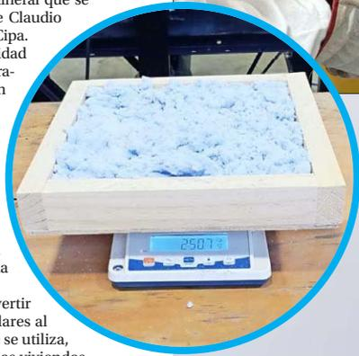
Mediante un proceso tecnológico, CIPA transforma residuos como las botellas plásticas en un material aislante.
