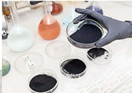
Neumáticos usados para purificar aguas contaminadas.
