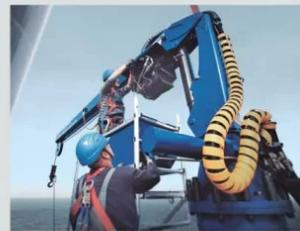
Grúas de brazo articulado, rígido, telescópico y abatible. Davits y botes de rescate para embarcaciones. Los equipos de Palfinger Marine están diseñados para operar bajo estándares rigurosos de seguridad y enfrentar las condiciones extremas en el sector marítimo y offshore.
