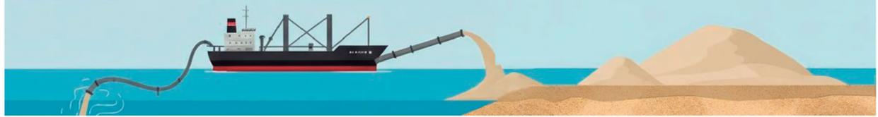
Dragas hidráulicas de succión extraen arena, la bombean y la van depositando en capas sobre aguas poco profundas, creando gradualmente una nueva superficie artificial. Si es necesario mover arena desde otros sitios, se usan dragas mecánicas y barcas de carga.
