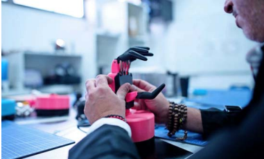
Commander es una unidad de activación creada en la UTEM, que permite entrenar al paciente previo al uso de una prótesis y de esa forma mejorar su capacidad motriz.
