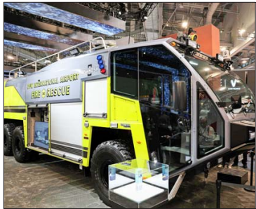
El Oshkosh Striker Volterra es un carro eléctrico de rescate y extinción de incendios ideado para aeropuertos. Es 28% más rápido que uno de diésel.
