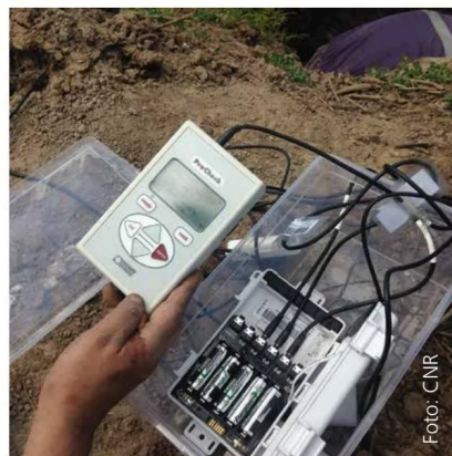
Una sonda de humedad mide en tiempo real el contenido de agua en el suelo.
