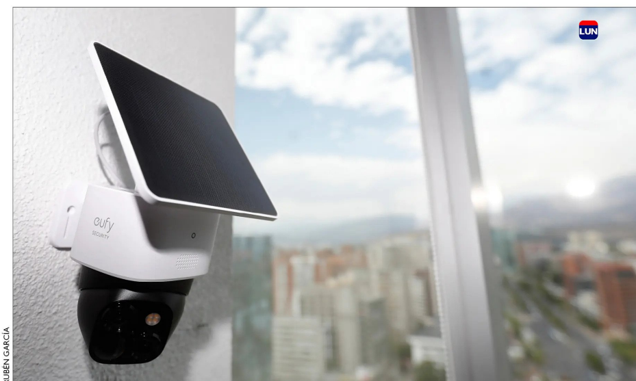
La Eufy SoloCam S340 incluye panel solar, batería de larga duración, doble lente, detector de movimiento y comunicación bidireccional desde el celular.
