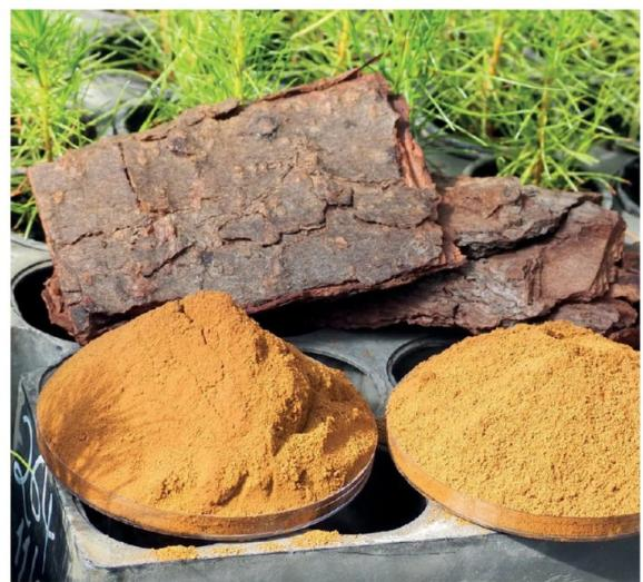
LA LIGNINA KRAFT, SUBPRODUCTO del proceso de la celulosa, demostró su potencial en la minería: Altavitaec utilizó este material para crear un supresor de polvo sostenible.
