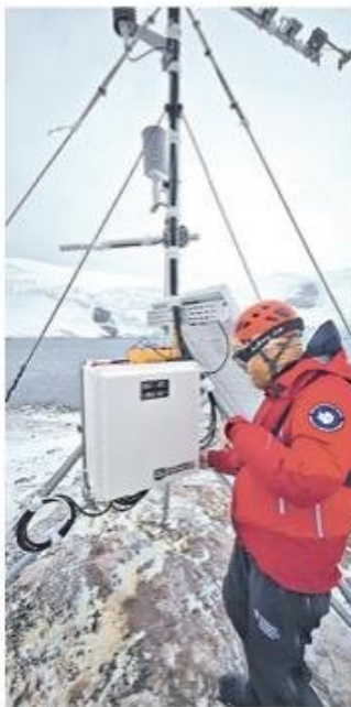
Estación automática registra variables climáticas en tiempo real como temperatura, viento y radiación solar.
