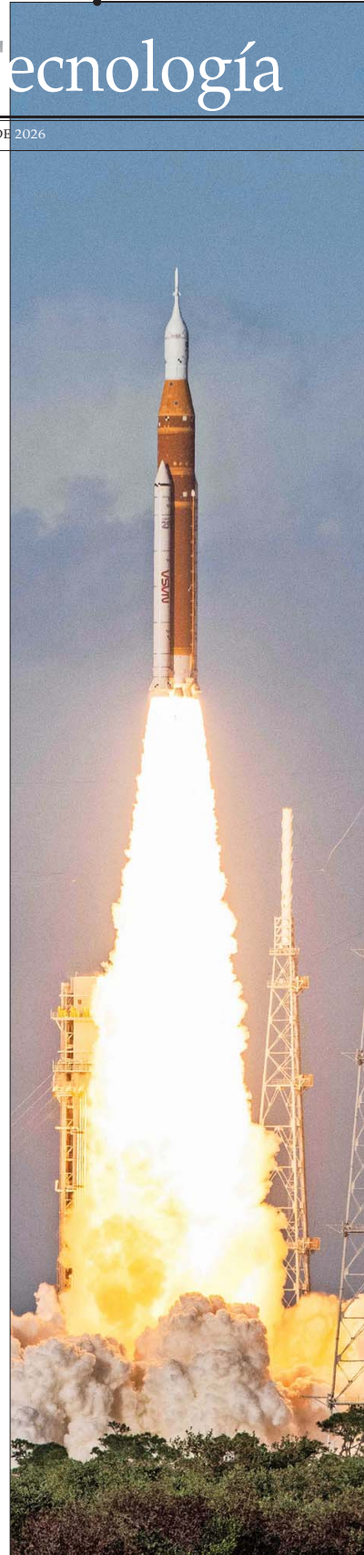
El Space Launch System (SLS) es el cohete que se usó en esta misión. No es el más grande que haya realizado una misión tripulada —mide 98,1 m de altura (como un edificio de 33 pisos), pero el Saturn V, que hizo 9 vuelos tripulados a la Luna entre 1969 y 1973 medía 110,6 m—, pero sí es el más potente del mundo.
