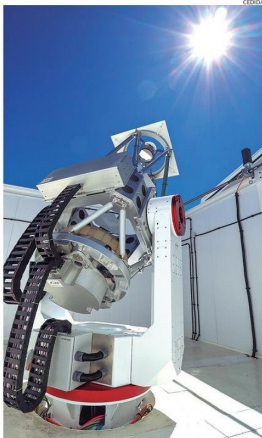
EL TELESCOPIO PRINCIPAL TIENE UN ESPEJO DE 60 CM QUE RECOGE LA LUZ DE PEQUEÑAS REGIONES DEL DISCO SOLAR.
