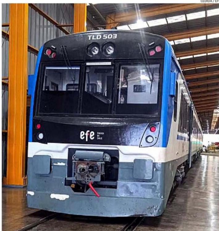
EL AUTOMOTOR TLD 503 FUE DERIVADO A SANTIAGO, PARA EL REPERFILADO DE SUS RUEDAS.
