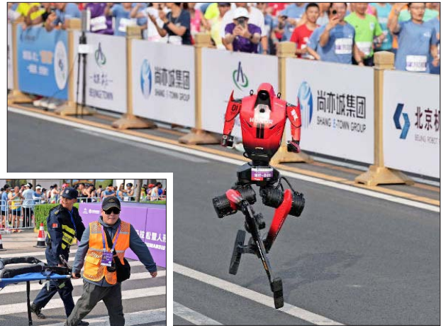
El robot ganador fue diseñado con piernas de unos 95 cm de largo, simulando características de corredores de élite.
