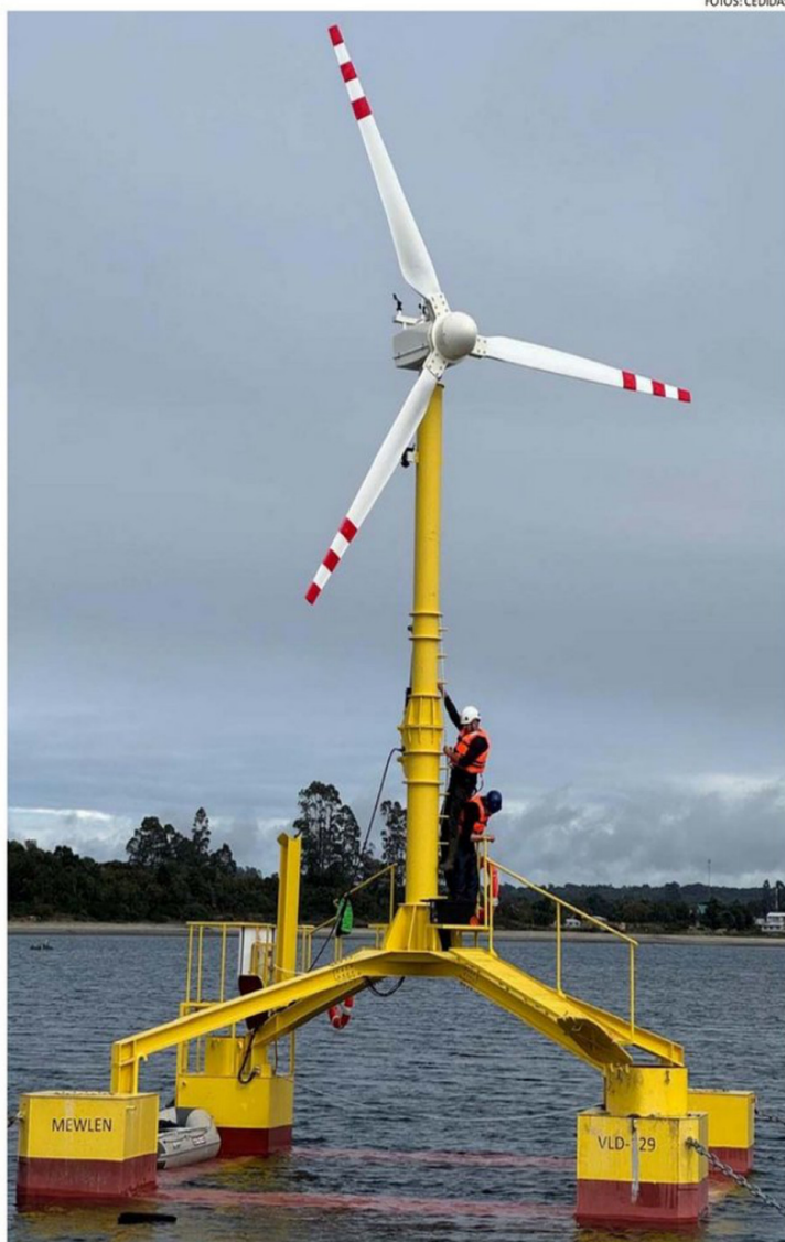
EL DISPOSITIVO SE ENCUENTRA EQUIPADO CON UNA TURBINA DE 10 KILOWATTS.
