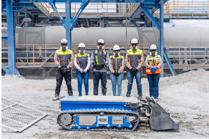
El E-Dozer es un bulldozer eléctrico operado de forma remota diseñado para operar en entornos complejos.
