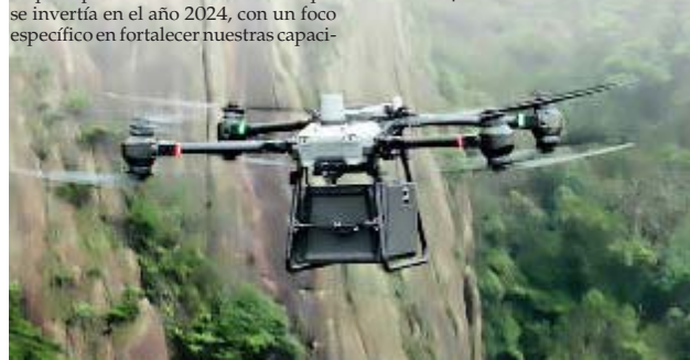
CGE adaptó dos drones de carga de DJI, uno con una estructura de poda y el otro con un sistema para el lavado de aislación de redes.
