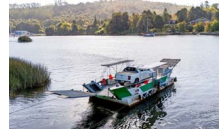
La barcaza funciona sin tripulación y utiliza energía solar. Demora algo más de cuatro minutos en cruzar el canal.
