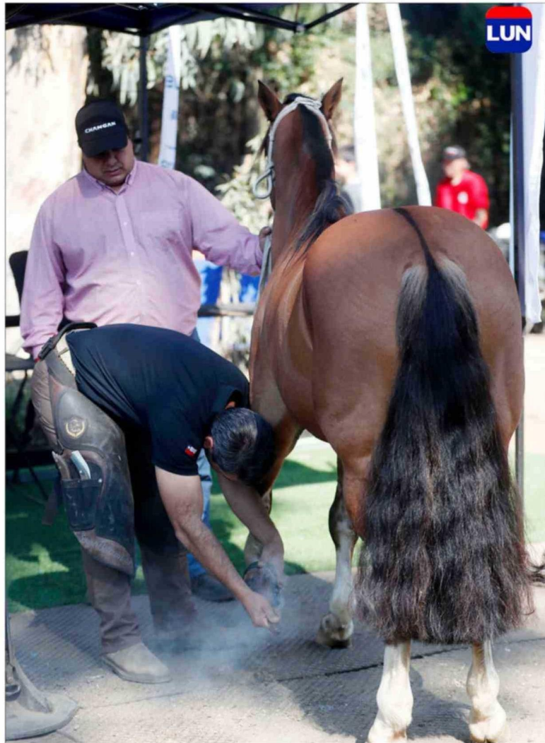
La herradura se calienta hasta el rojo, al menos a unos 600° Celsius.
