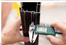
Proceso de medición de parámetros de perfiles para ventanas de PVC.
