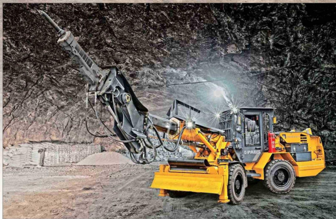
La acuñadora de Soilfe sirve para remover material que pueda desprenderse dentro de los túneles mineros.
