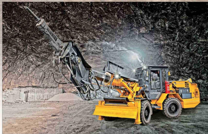
La acuñaadora de Soilfe sirve para remover material que pueda desprenderse dentro de los túneles mineros.
