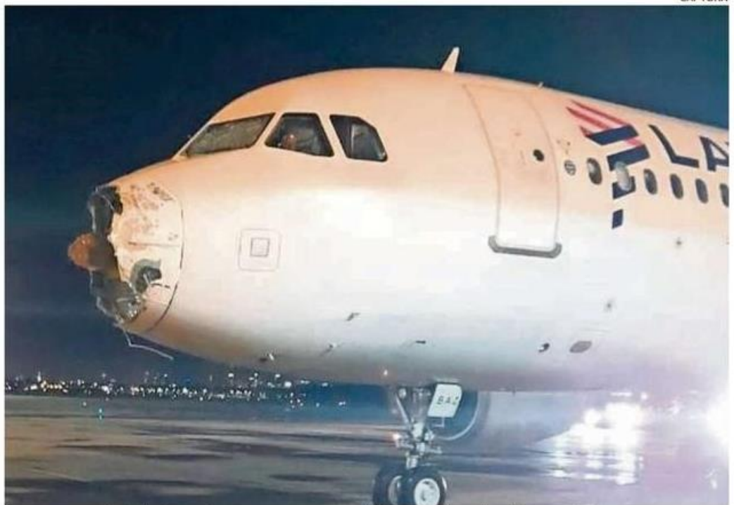
La aeronave aterrizó sin uno de sus motores y con daños en radomo (nariz) y parabrisas.
