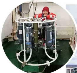
La Dra. Andrea Corredor, de nacionalidad colombiana, prepara la oseta con botellas oceanográficas para colecta de agua a diferentes profundidades.
